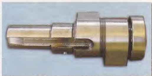
Arbol de levas con un rodamiento y apoyo directo en la culata
